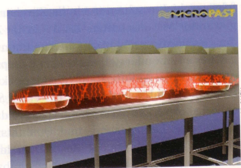
Im Mikrowellentunnel kann gleichzeitig das Produkt gekocht und pasteurisiert werden
